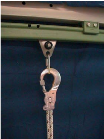
Abb. 17 Anschlagrichtung mit horizontaler Führungsschiene und beweglichem Anschlagpunkt
