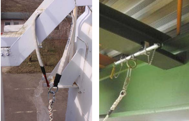
Abb. 14 Beispiele für Anschlageneinrichtungen der Klasse B – Bandschlinge, Trägerklemme
