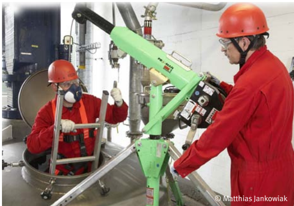
Abb. 5 Rettungshubgerät der Klasse B
