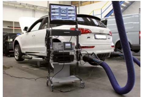
Bild 17-1: Abgasabsaugung mit oberirdischer Anlage
