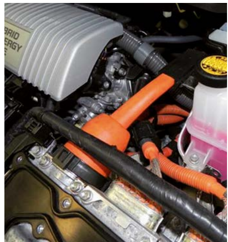
Bild 8-2: Orange gekennzeichnete HV-Kabel
