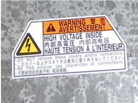
Bild 8-3: Beispiel einer Kennzeichnung von HV-Komponenten
