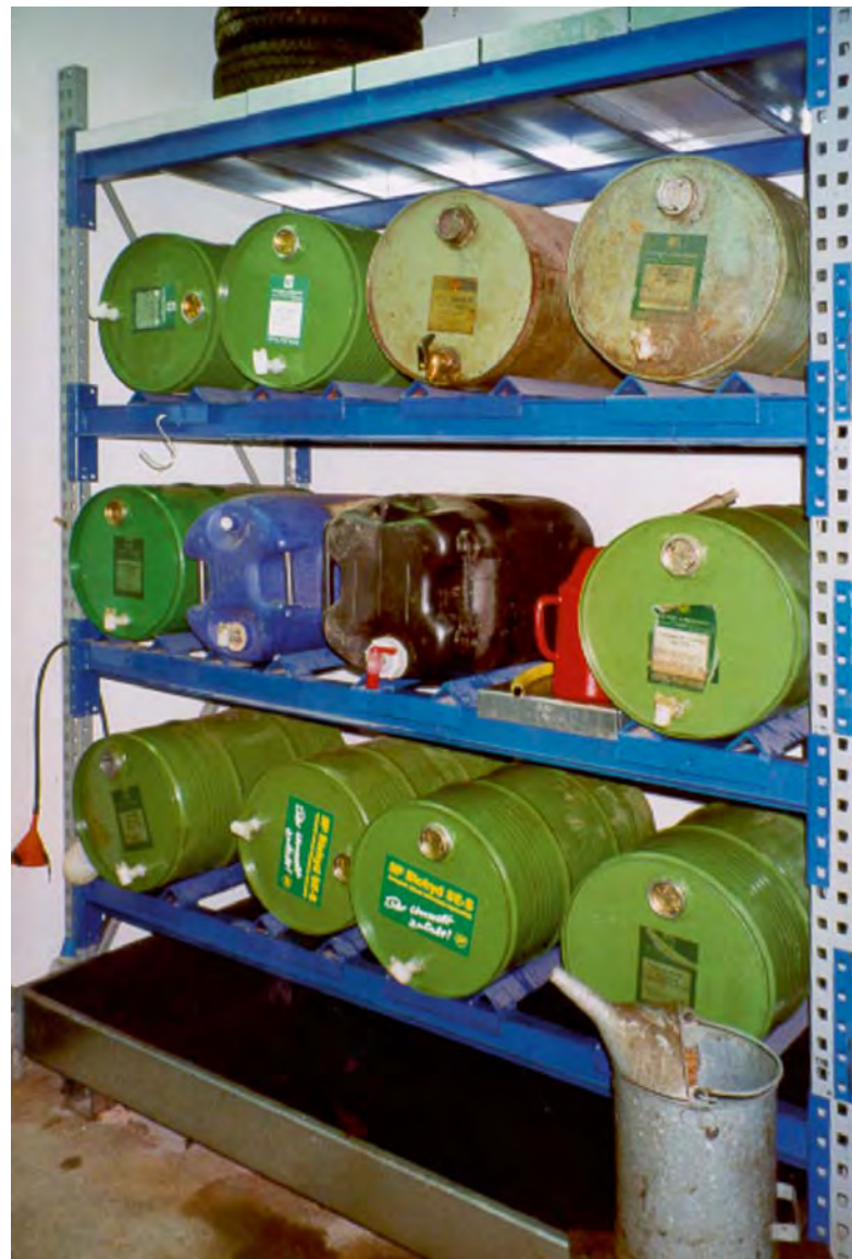
Abb. 7 Schmierstofflager mit Auffangwanne
