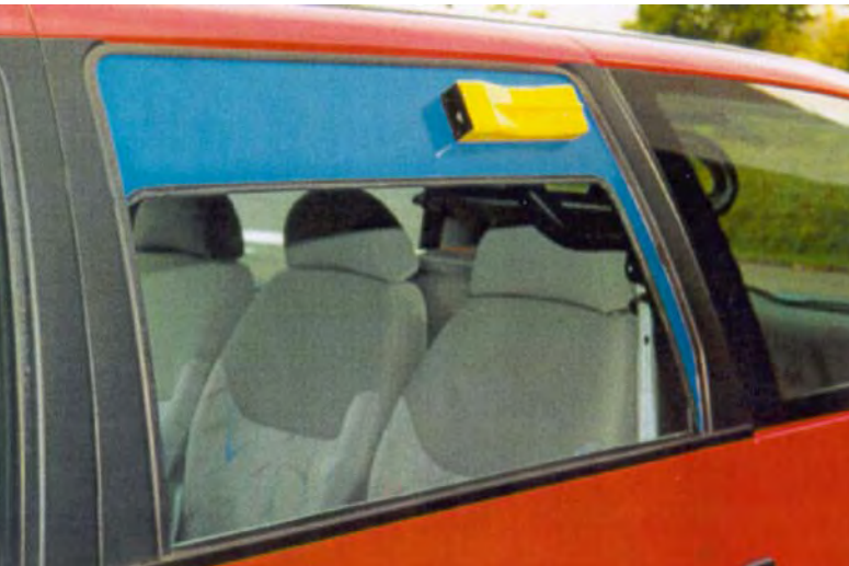
Abb. 6 Zwangselüftungssystem- TOXBOX, Seitenscheibeneinbau
