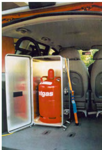
Abb. 5 Transportbehälter mit Zwangsbelüftungssystem-TOXBOX
